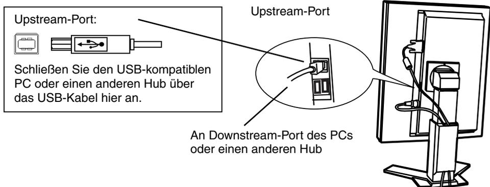
3. Nach Einrichtung der USB-Funktion steht der USB-Hub des Monitors für den Anschluss von USB-kompatiblen Peripheriegeräten zur Verfügung. Schließen Sie die Geräte an die Downstream-Ports des Monitors an.
