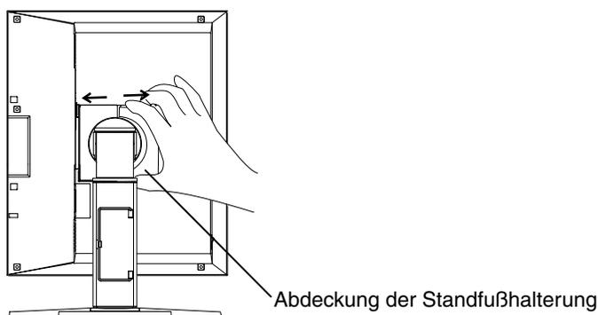
2. Fassen Sie die Abdeckung der Standfußhalterung in der Mitte und schieben Sie sie nach rechts oder links, um an die Schrauben zu gelangen, mit denen der Standfuß am Monitor befestigt ist.
