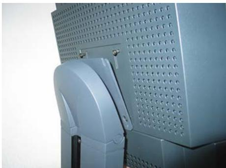
3. Zuerst zwei Schrauben in die unteren beiden Bohrlöcher des Standfußes einführen.
