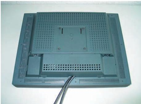
1. Befestigen Sie die Anschlusskabel vor dem Montieren des Standfußes am Monitor.
