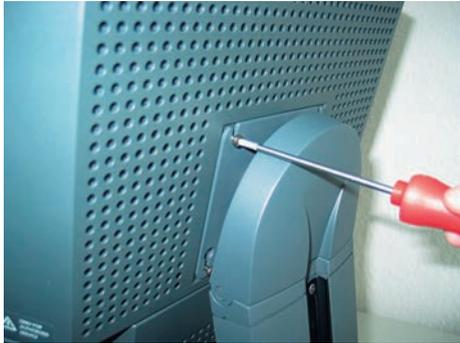
6. Zuerst die oberen beiden Schrauben festdrehen.
