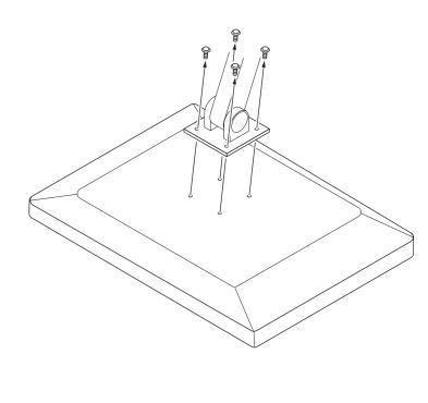
3. 取り付けプレートをモニターとアームの間にはさみ、確実に取り付けます。 適切なねじを使用してください。
